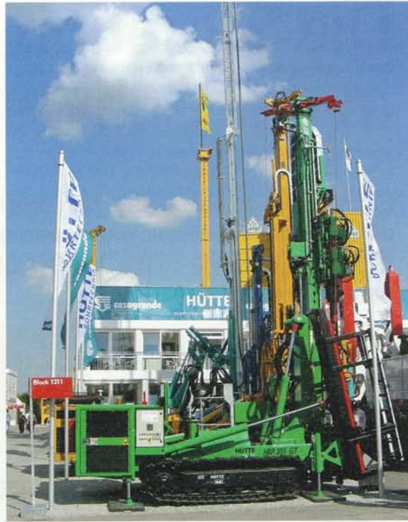
Links: Ganz auf die Belange der oberflächennahen Geothermie abgespeckt: Die Rotamax-Bohrgeräte von Geotec Bohrtechnik, Nordkirchen.
