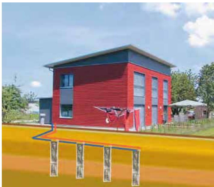
Abbildung 4.8: Erdwärmekörbe (Bild: Calmotherm)
