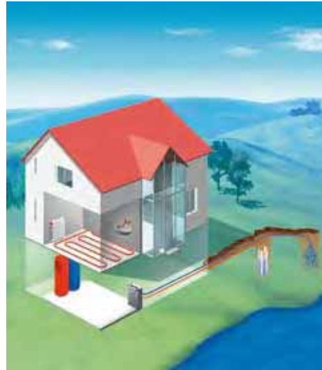
Abbildung 4.15: Entnahme- und Rückgabebrunnen (Bild: Hoval)
