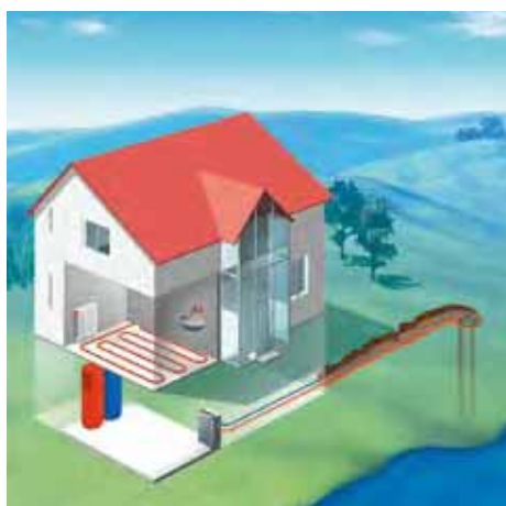
Abbildung 4.4: Erdwärmesonde (Bild: Hoval)
